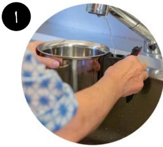
1 Wachsschmelzgerät mit Wasser nicht zu voll füllen. Anleitung des Geräts beachten. Wasser auf niedriger Temperatur erwärmen. Wasser darf nicht kochen, sonst spritzt es aus der Einfüllöffnung. Es sollte unbedingt vermieden werden, dass Wasser ins Wachs spritzt.
