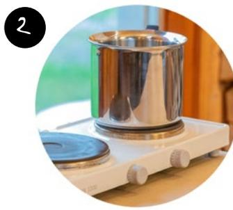
2 Allfällige Wassertropfen trockenreiben bevor man das Wachs in den Behälter legt. Raps-Kokoswachs im Wasserbad schmelzen. Temperatur ca. 75°C. Dies dauert ca. eine halbe Stunde.
